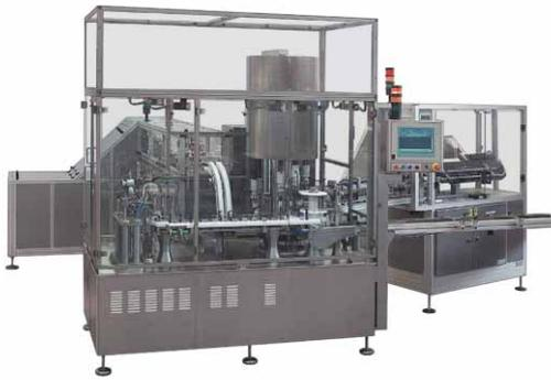
мым скоростным автоматом на европейском рынке, оснащен бесщеточными моторами и сдвоенной группой дозирования, что дает производительность на 60% выше традиционных машин (до 100-120 шт./мин. контейнеров туши для ресниц). Операционный цикл машины может быть разбит на 5 составляющих: автоматическая подача контейнеров и укупорочных элементов, шаговое перемещение контейнеров, дозирующая система, система загрузки и закрытия колпачком непрерывного действия, система электронного контроля через РС.
