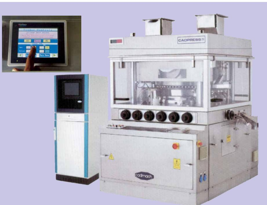
**Высокоскоростной таблеточной пресс, производительностью до 540 000 таблеток в час с системой автоматизации**
