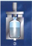
Следующим шагом является **запайвание**. Верхняя часть контейнера, которая остается открытой и находится в горячем пластичном состоянии, сжимается в пресс-форме, его верх заваривается и одновременно охлаждается. В результате получается герметично закрытый контейнер.
