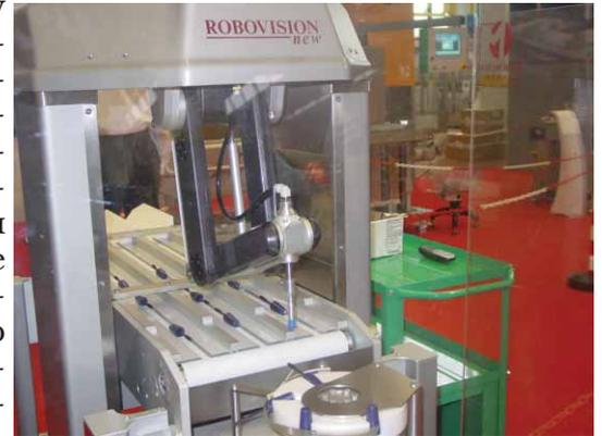
го введения в ячейку картонера. Сконструированная для непрерывного действия, система позволяет использовать как параллельные, так и пересекающиеся конвейеры. Этот абсолютно новый продукт компании предоставляет максимум гибкости и точности. Программное обеспе-
