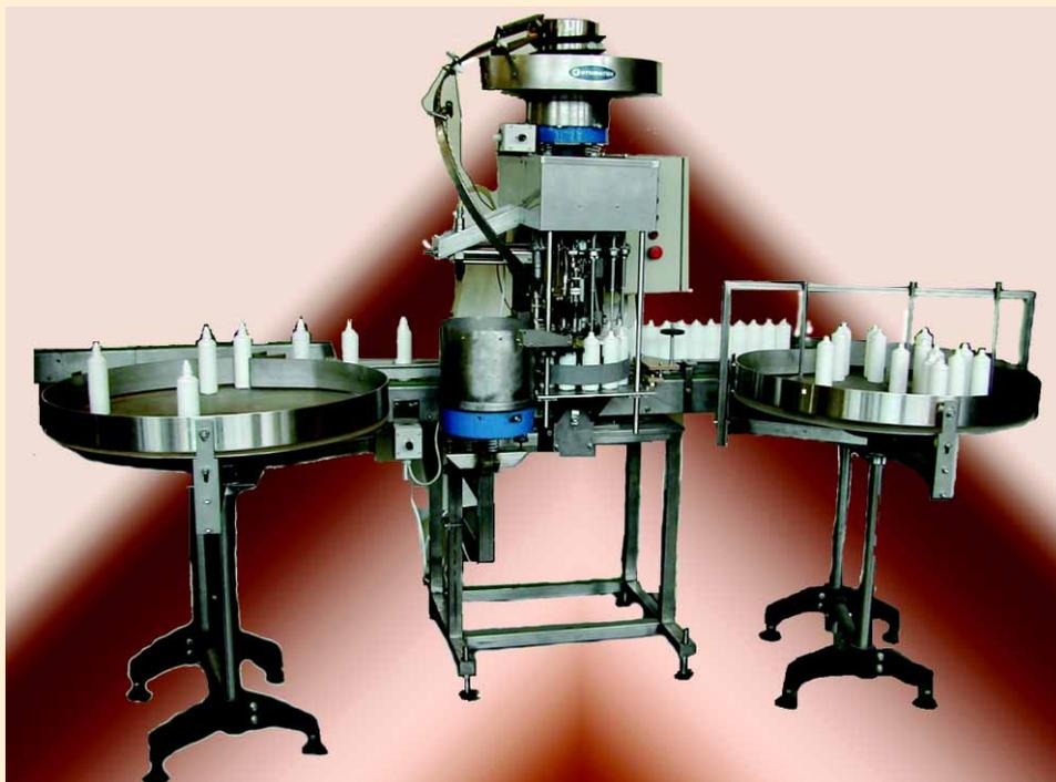
Эти предпосылки определили **структуру автомата АО 27**. Два основных рабочих органа - поворотный-индексируемый стол (с быстросменными гнездами под наполняемые флаконы) и центральный ползун (с регулируемым по высоте расположения наливными наконечниками, устройствами одевания и затяжки деталей укупорки) управляются единым распределительным валом, приводимым во вращение электродвигателем мощностью всего 120 вт. Создать такую машину быстро нам в значительной мере помогло то, что в основу её
