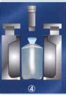
Далее происходит удаление облоя или отходов, обрезка контейнера и выход его из машины. Весь процесс экструзии-формования-наполнения-запайки и удаления облоя занимает от 12 до 18 секунд, в зависимости от типа и размера контейнера.
