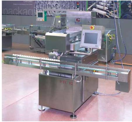
та в упаковочных линиях. **Robovision** был разработан для укладки продукта, поступающего в хаотичном порядке на конвейер, и последующей подачи на автомат-картонер непрерывного действия. Благодаря видеокамере и программному обеспечению, **Robovision** распознает картинку поступающего продукта и может позиционировать продукт для корректно-
