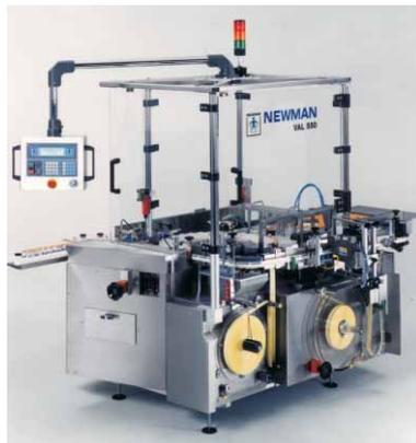
процесса нанесения этикетки. В противоположность этому, специальная разработка компании Newman позволяет наносить этикетку в вертикальном положении, сохраняя его в течение всего производственного процесса через этикетировочную машину, тем самым, достигая наилучших показателей по скорости машины и щадящему обращению со шприцами.
