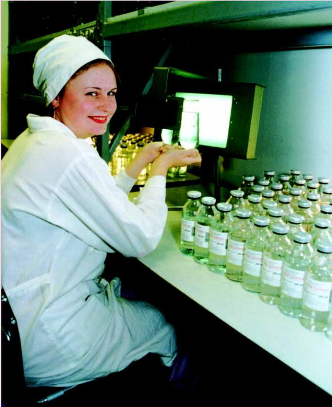
Прибор для контроля растворов на механические включения «Светлячок»™
