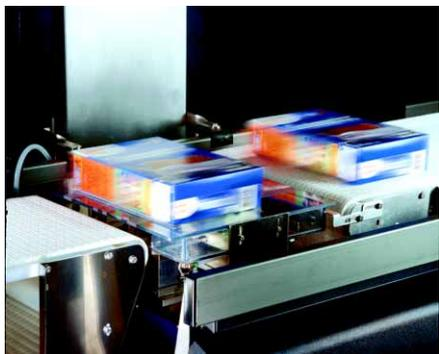
ток с данными взвешивания и штрих-кодом. Такие системы легко встраиваются в различные производственные и транспортные конвейеры.
