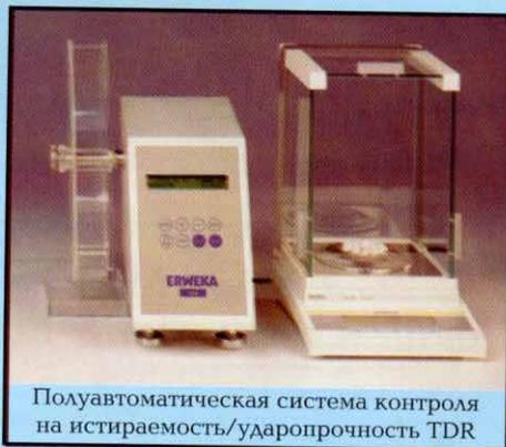
Полуавтоматическая система контроля на истираемость/ударопрочность TDR
