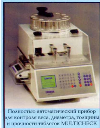
Полностью автоматический прибор для контроля веса, диаметра, толщины и прочности таблеток MULTICHECK
