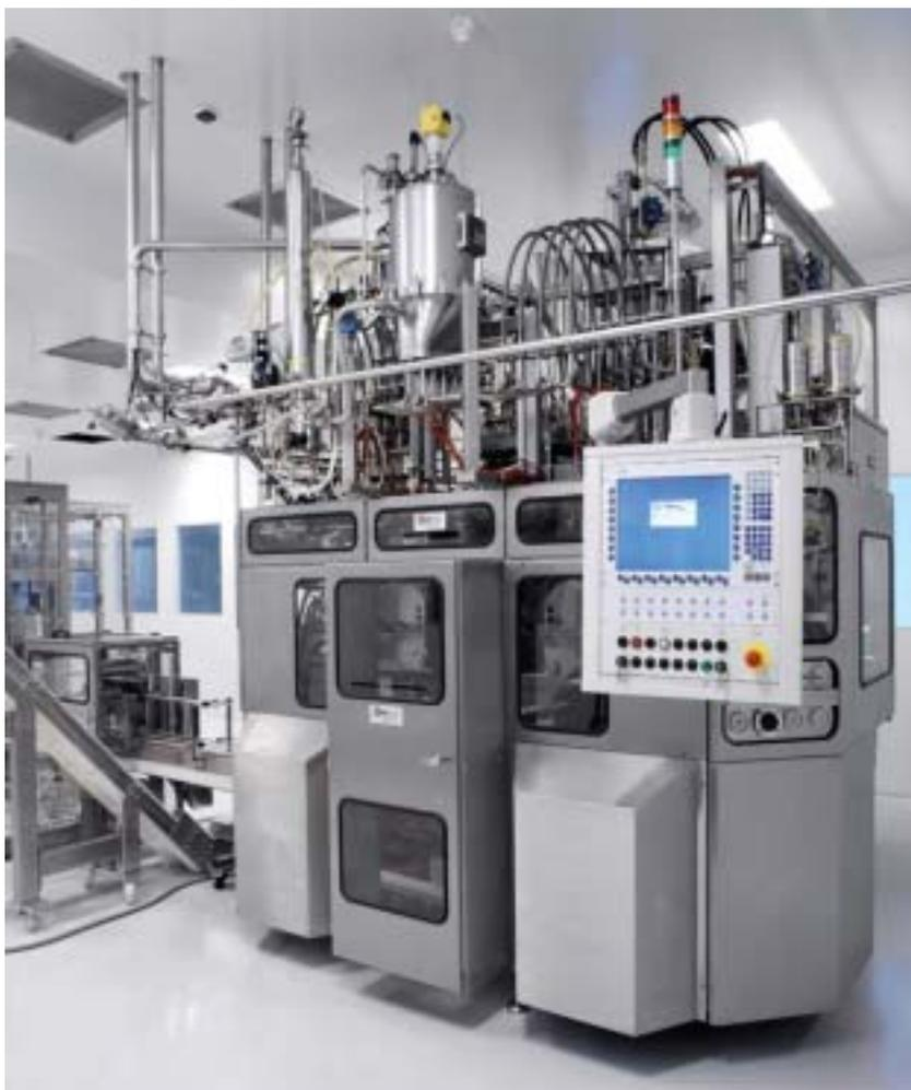
*Установка розлива в бутылки инфузионных растворов по технологии Blow-Fill-Seal*
